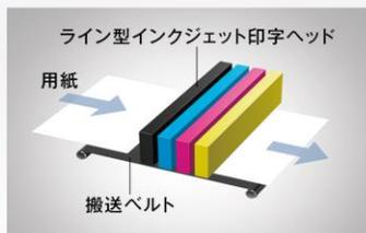
A3ワイド相当の用紙(短辺幅)を、一度に印字できる「**ライン型インクジェット印字ヘッド**」などにより、圧倒的な高速プリントを実現。
